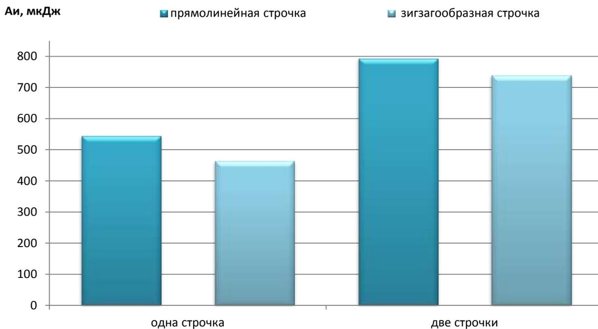
Рис. 4.14. Влияние количества строчек на работу изгиба бортовых тканей в системе, имитирующей бортовую прокладку
