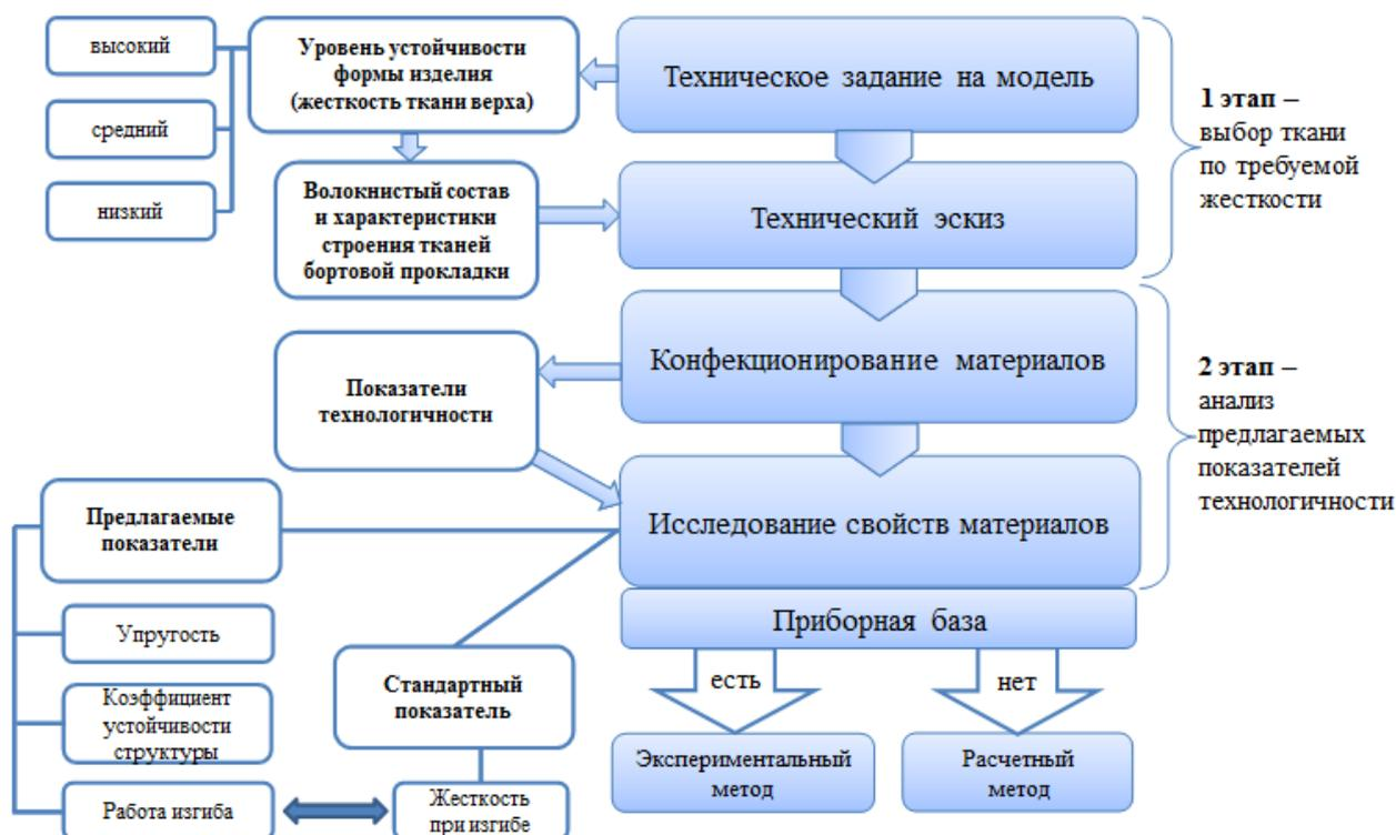
Рис. 5.1. Алгоритм выбора бортовых тканей для бортовой прокладки
