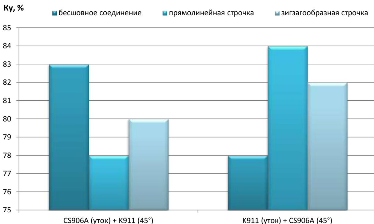
Рис. 4.10. Показатели коэффициента устойчивости структуры в системах бортовых тканей разного артикула
