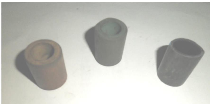
Рис.5.18. Резиновые втулки, для установки колосников в боковинах и промежуточных кронштейнах
