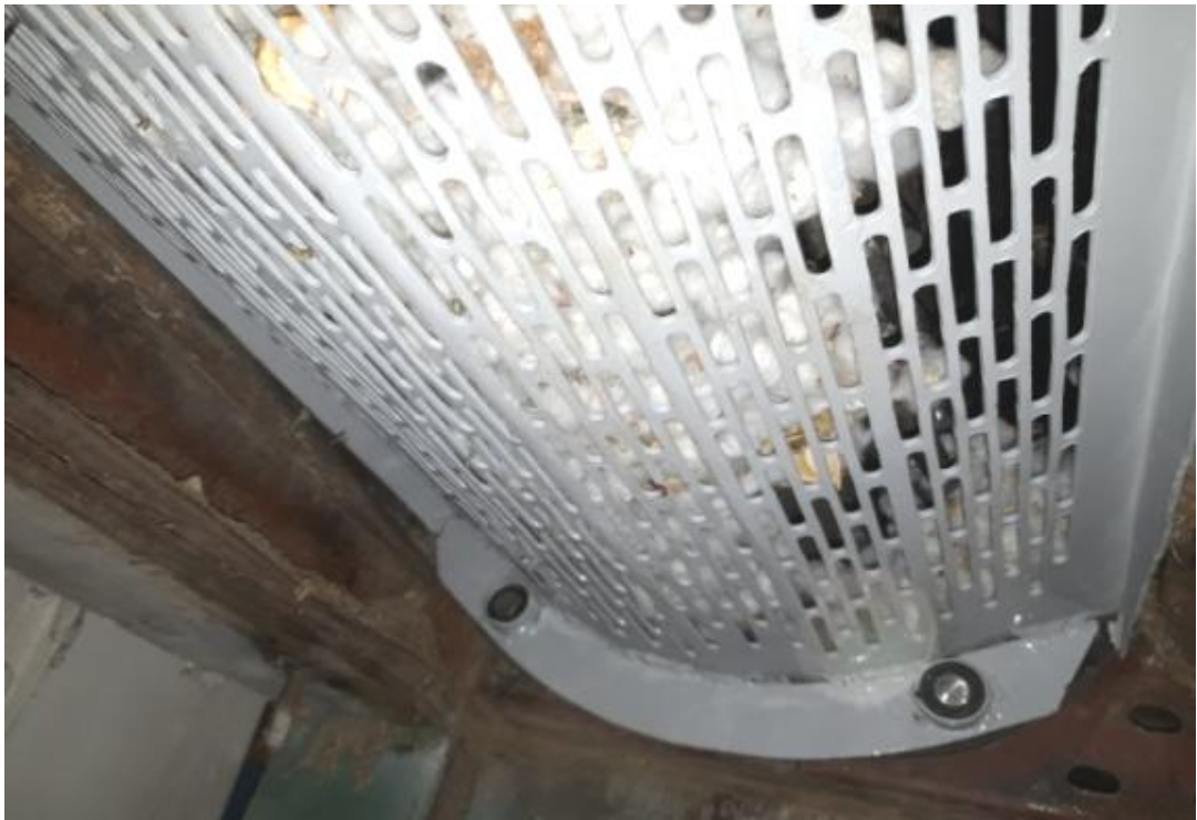
Рис. 5.10. б - Фотоснимки зоны очистки хлопка с использованием многогранной сетчатой поверхности
