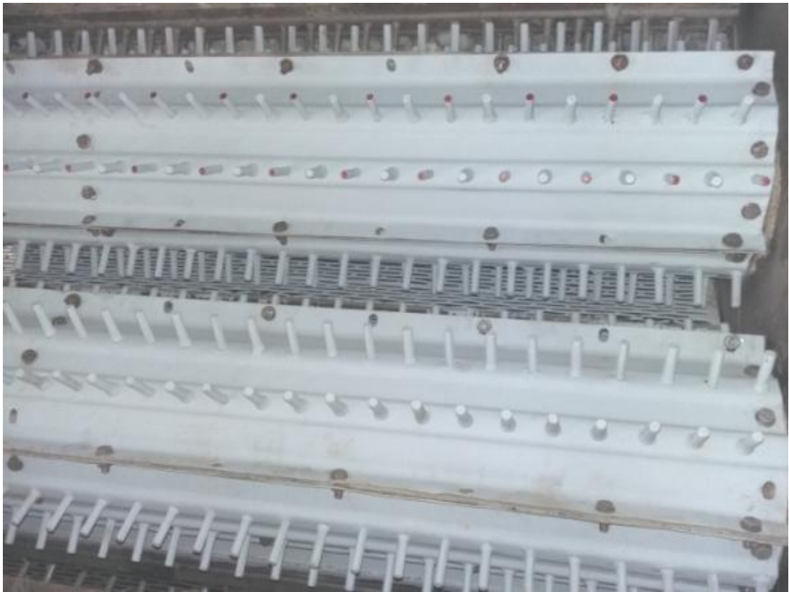
Рис. 5.10. а - Фотоснимки зоны очистки хлопка с использованием барабанов с многогранными сетками
