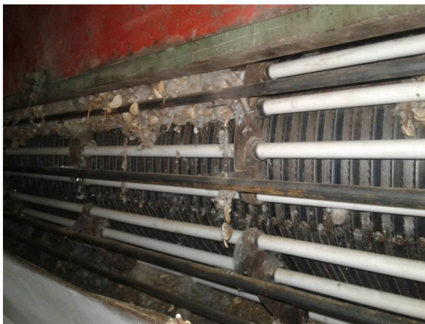
а-при использовании композитных колосников на упругих опорах
