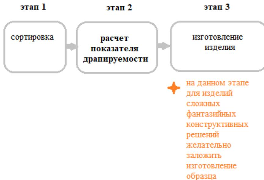
Рис. 5.2 – Предлагаемая схема процесса изготовления изделий из овчины
