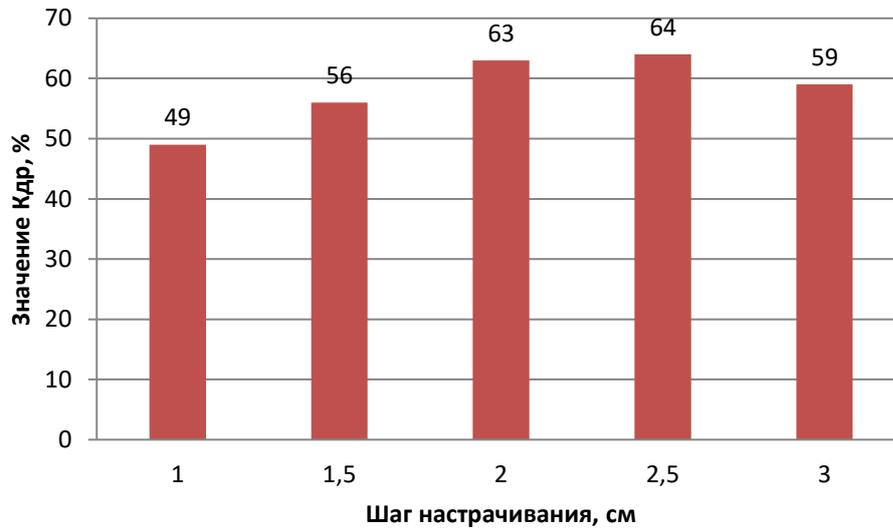
Рис. 5.7 – Зависимость  $K_{др}$  от шага настрачивания меховой нити
