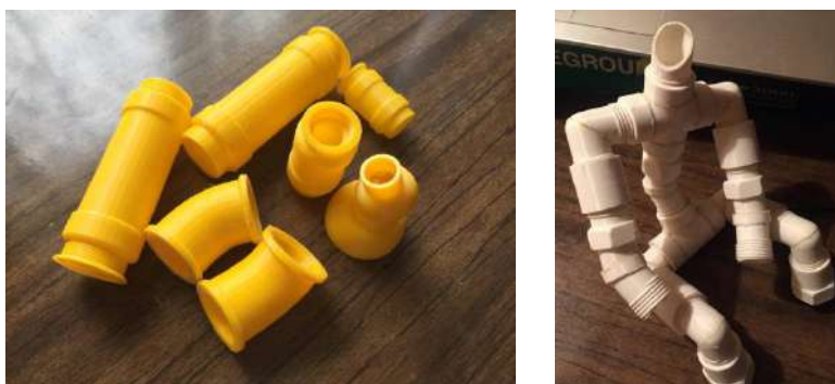
Рис. 2. Детали светильника, напечатанные в пластике PLA
