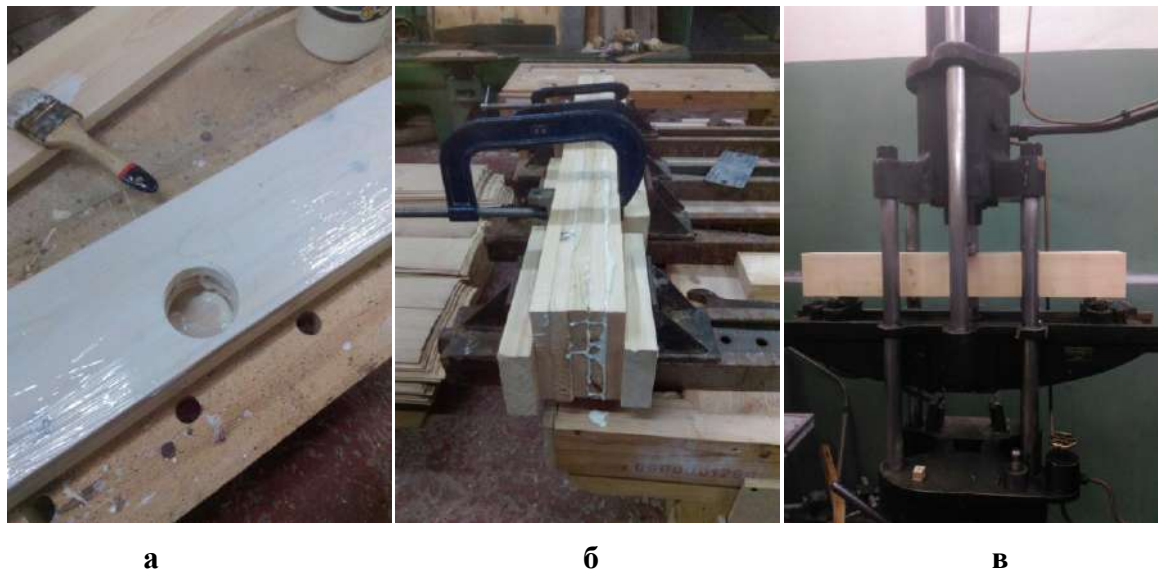
Рис. 2. Процесс создания и испытания клееных балок: а – вид внутренней ламели с отверстием D_1=60 мм и нанесенным клеем; б – общий вид клееного бруса во время запрессовки в вайме; в – вид испытательной установки с установленным в ней образцом КДБ
