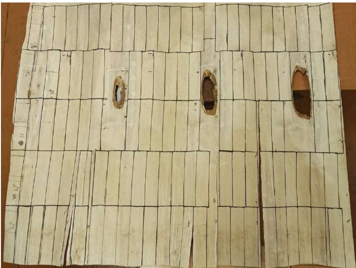
Рис. Общий вид листа шпона: а – раскроенного «слепым» способом; б – раскроенного индивидуальным способом
