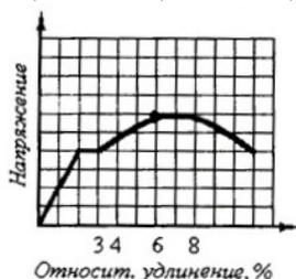
№ 3. На рис. изображена диаграмма растяжения для условных напряжений. Поведение каких металлов она отражает?
