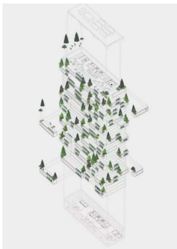
Рис. 3. Схема Bosco vertical. Правильное расположение растений
